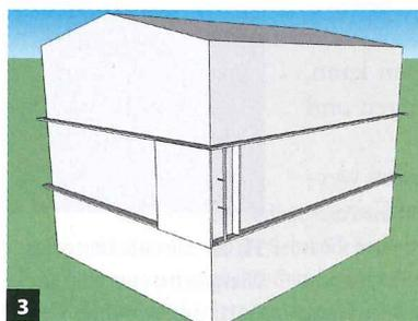
**2** Die Montage des Wandsystems smartshell reno beginnt mit dem Anbringen der umlaufenden Riegel in der Ebene der Geschossdecken. Beim Befestigen des Riegels können Altbautoleranzen problemlos ausgeglichen werden.
