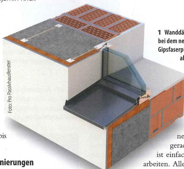
**1** Wanddämmung und Fensteranschluss gehen bei dem neuen Bausystem ineinander über. Eine Gipsfaserplatte deckt den Spalt zwischen der alten, inneren Putzkante und dem neuen Blendrahmen ab. Es muss also auf der Innenseite der Leibung weder Putz abgeschlagen noch die innere Putzkante erneuert werden. Die Bewohner bleiben von Lärm und Schmutz bei der sehr schnellen Montage weitgehend verschont.
