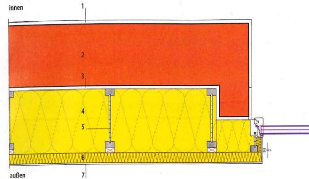
**7** Horizontalschnitt durch das Blumenfenster beim Pilotprojekt mit Aufbau des Wandsystems. Das Grundsystem wurde in der Dämmdicke an die vorstehenden Lisenen angepasst, um eine plane Oberfläche bei der Außenwand zu erhalten. Die aufgedoppelte Holzleiste an der äußeren FJI-Wange ergibt sich aus den Standardbreiten der Holzständer.
